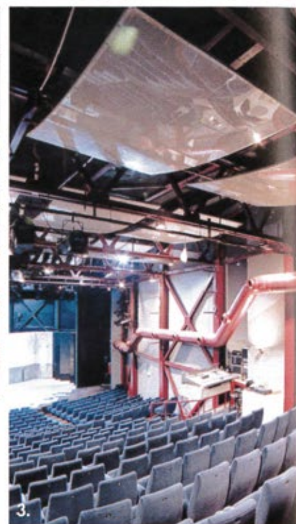
Εικόνες 1 & 2. Η αίθουσα και η σκηνή του θεάτρου ΗΒΗ από δύο διαφορετικές οπτικές γωνίες. Εικόνα 3. Λειτουργικά στοιχεία όπως οι ανακλαστικές του ήχου από Plexiglas στην οροφή και ο κλιματιστικός αεραγωγός του χώρου που ακολουθεί την κλίση της πλατείας συνθέτουν την αισθητική ταυτότητα του χώρου.
